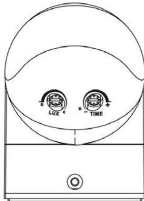
**HINWEIS:** Sollte der Test bei Tageslicht erfolgen, so stellen Sie bitte sicher, dass das LUX-Drehrad zur Gänze zum Sonnensymbol gedreht ist. Andernfalls funktioniert die durch den Sensor geschaltene Last nicht.
