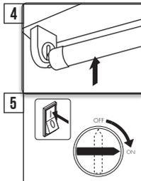
4 Setzen Sie die LED-Röhren in die Fassung
